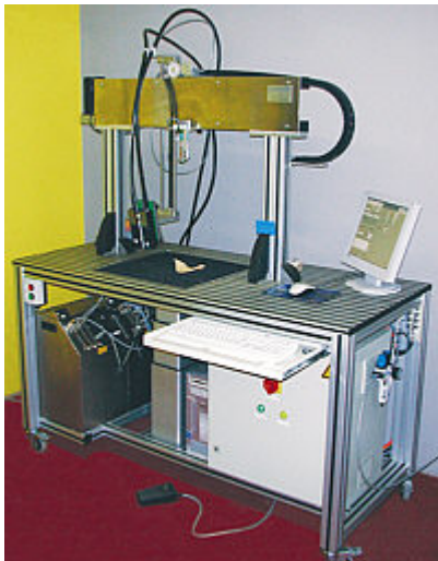
Abb. 10 Maschine zur Beschriftung von Fundobjekten.
