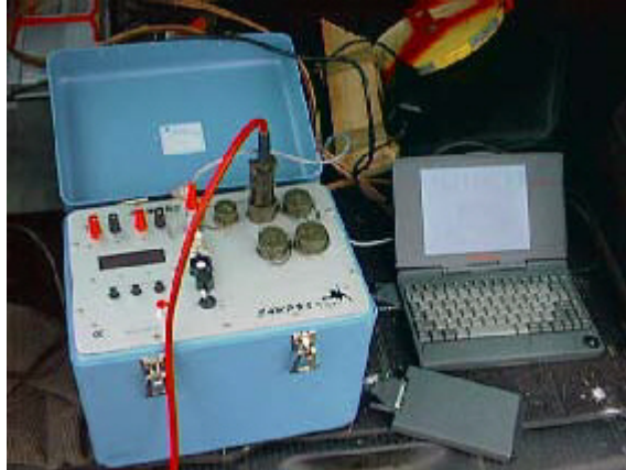
Abb. 1 Multielektrodenmessgerät Campus Tigre
